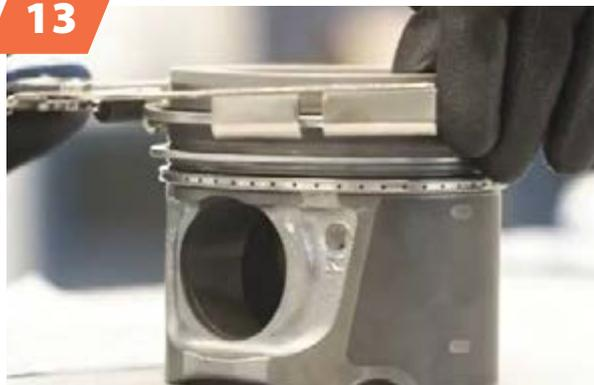
Retífica: dicas para montagem de anéis de segmentos de motores, conferindo posicionamento nas três canaletas
