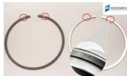
**3 /** É fundamental utilizar ferramentas adequadas para montar os anéis de segmento no pistão, como o alicate apropriado, para evitar deformações e danos, e muito cuidado com a abertura entre as pontas, pois, se excessiva, pode ocasionar danos permanentes. Além disso, a montagem manual pode resultar em deformação, como na torção do anel e travamento na canaleta.
