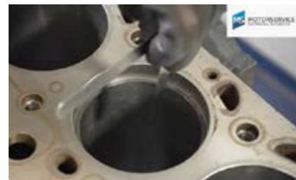
**2 /** Os anéis de segmento possuem posição de montagem referente ao topo do pistão, seguindo as indicações das gravações TOP ou KS.
