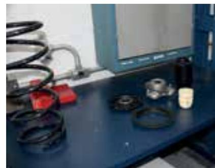
Juntamente com os amortecedores, o mecânico deve verificar também outros componentes como o coxim, a coifa, o batente e a mola. Se apresentarem desgastes, também devem ser substituídos, dessa forma todo o conjunto trabalhará na mesma condição, segundo a Cofap.
