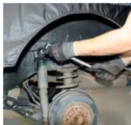
A Nakata avalia que é preciso verificar se não há rasgos ou furos em coifas e comprometimento dos outros itens. “Por serem muito exigidos, os pivôs devem ser substituídos em qualquer sinal de comprometimento. Bandeja e barra estabilizadora devem ser avaliadas com atenção. Qualquer sinal de folga nas bieletas ou buchas, estas devem ser substituídas. Já para bandejas, os sinais mais comuns de comprometimento são ruídos e desgaste irregular dos pneus”, diz o técnico.
