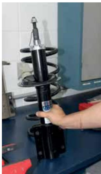
A Cofap esclarece que na avaliação, os amortecedores devem ser trocados imediatamente se constatados defeitos como vazamento de óleo; ruptura dos fixadores; perda total de ação; e travamento da haste (engripamento).
