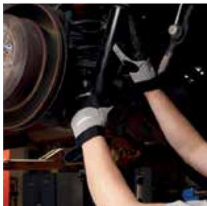
“Teste realizados pela fabricante mostram que os amortecedores se movimentam, em média, 2.625 vezes por quilômetro rodado. Assim, quando a peça completa 40 mil quilômetros de uso, sua movimentação alcança o total de 104 milhões de ações, o suficiente para provocar o desgaste natural dos componentes internos”, conta Juliano.
