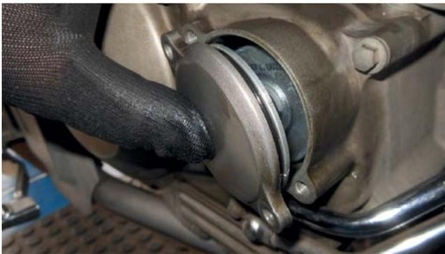
Se essa relação não for obedecida, ao colocar o mesmo filtro com óleo novo, uma quantidade do lubrificante contaminado fica no filtro usado, mas já sem propriedades. Esse óleo sem vida se mistura com o óleo novo diminuindo a sua capacidade.
