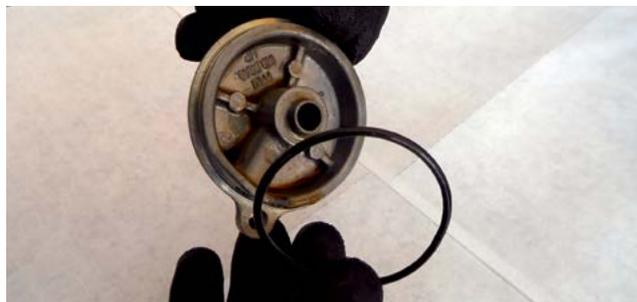
8) Reinstale o anel o'ring que vem no kit do filtro novo. É bom aplicar o óleo no anel o'ring antes de montar no alojamento.
