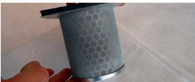
Caso tenha contaminantes dentro do motor, o seu desgaste passa a ser acelerado e muitos problemas, pois quando satura, ele fica sujo e entope, aumentando a dificuldade da passagem do ar e ocasionando aumento de consumo, perda potência, falhas de funcionamento, e conseqüentemente, maior emissão de poluentes.
