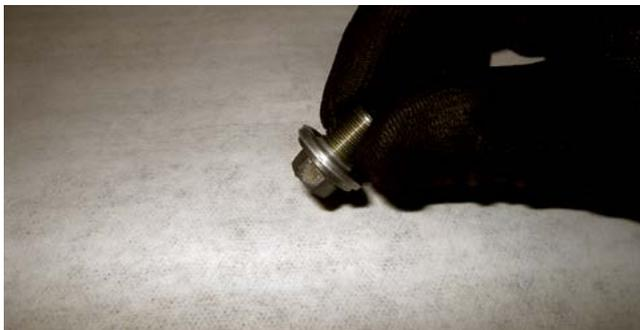
4) Retirar os dois parafusos do filtro de óleo, com uma chave 8mm.
