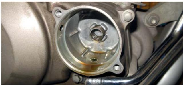
7) Retire com uma chave de fenda o anel o'ring usado.
