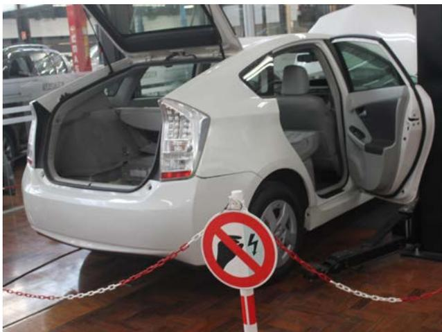
Isso exigirá novos equipamentos, como multímetros específicos para alta voltagem, isoladores, elevação especial, luvas, calçados específicos para o trabalho com alta tensão, e também a adequada sinalização para que o espaço seja seguro tanto para o mecânico quanto para outras pessoas que transitam pelo local.
