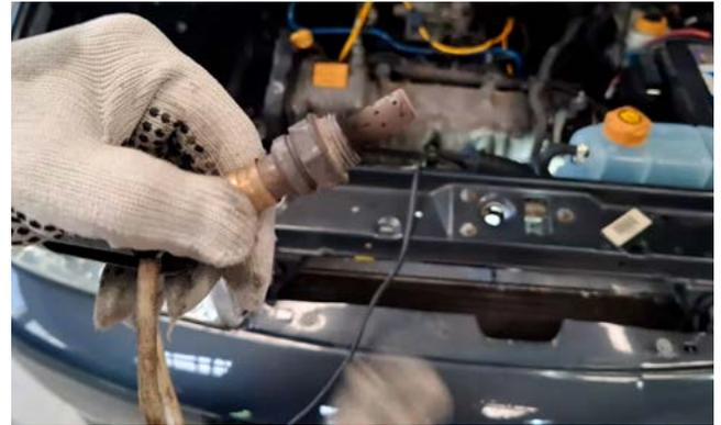
Para fazer a substituição é necessário utilizar uma ferramenta específica com rasgo uma abertura para passagem do chicote, sem danificar o sensor. A sonda foi removida e substituída por uma nova NTK.
