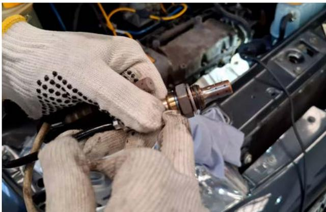
Para a instalação, use novamente a ferramental especial e faça o encaixe do conector.
