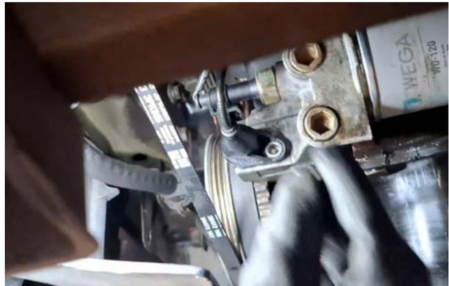
Em seguida, a nova unidade foi instalada com torque leve. Após reconectar o chicote e reinstalar a capa protetora, o osciloscópio confirmou a leitura correta.
