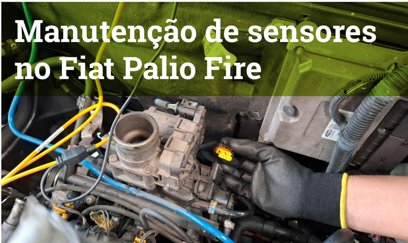
**D**esde que os carros aderiram à injeção eletrônica, os sensores passaram a exercer papel vital para o funcionamento correto do motor. No Fiat Palio Fire 1.0, ano 2004, a inspeção e substituição de componentes como o sensor de rotação, a sonda lambda (sensor de oxigênio) e o sensor MAP garantem desempenho, economia de combustível e redução de emissões.
