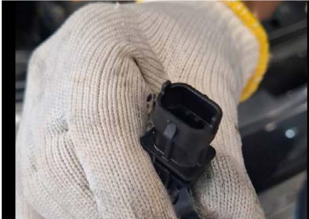
A partir desse sinal, o módulo de injeção reconhece a rotação do motor e sincroniza tanto a ignição quanto a injeção de combustível. Quando há falha nesse componente, o motor sequer entra em funcionamento, já que não recebe a informação básica de que está girando.
