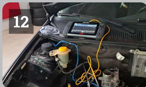
**Mecânica Leve:** Acompanhamos a manutenção dos sensores de rotação, MAP e sonda lambda do Fiat Palio motor 1.0 Fire
